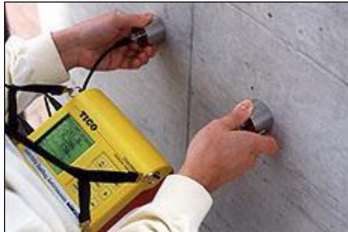
Photo 48 - Prise de mesures ultrasoniques
