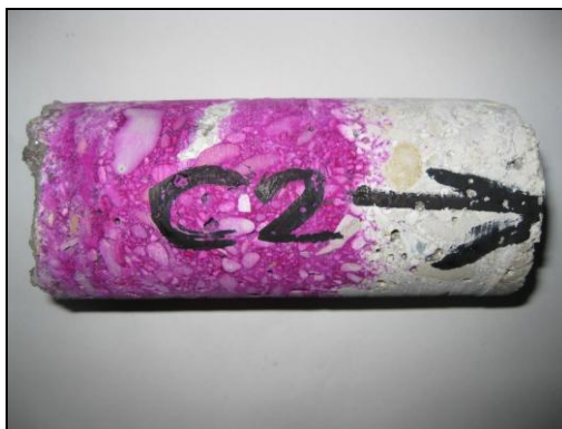
Photo 50 - Mesure de carbonatation sur un échantillon
