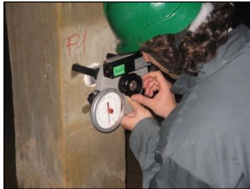
Photo 51 - Mesure d'essai dynamométrique
