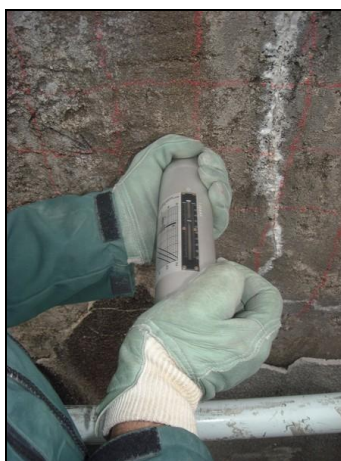
Photo 49 - Prise de mesures sclérométriques
